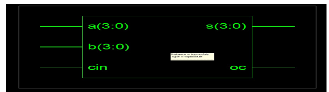
Fig. 12: RTL schematic of top module
